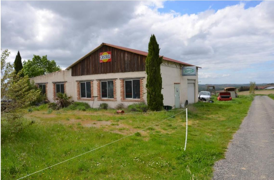
Cette construction de forme rectangulaire possède une toiture à deux pentes en panneaux sandwichs, prolongée par des tuiles.
